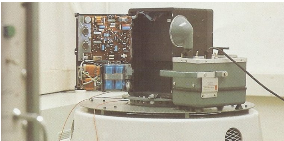
FIGURE 13 – Installation pratique dans la chambre anéchoïque (photo temporaire).
