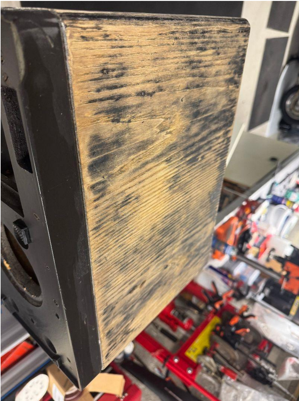
Pose du mastic bois et filler plastique :
