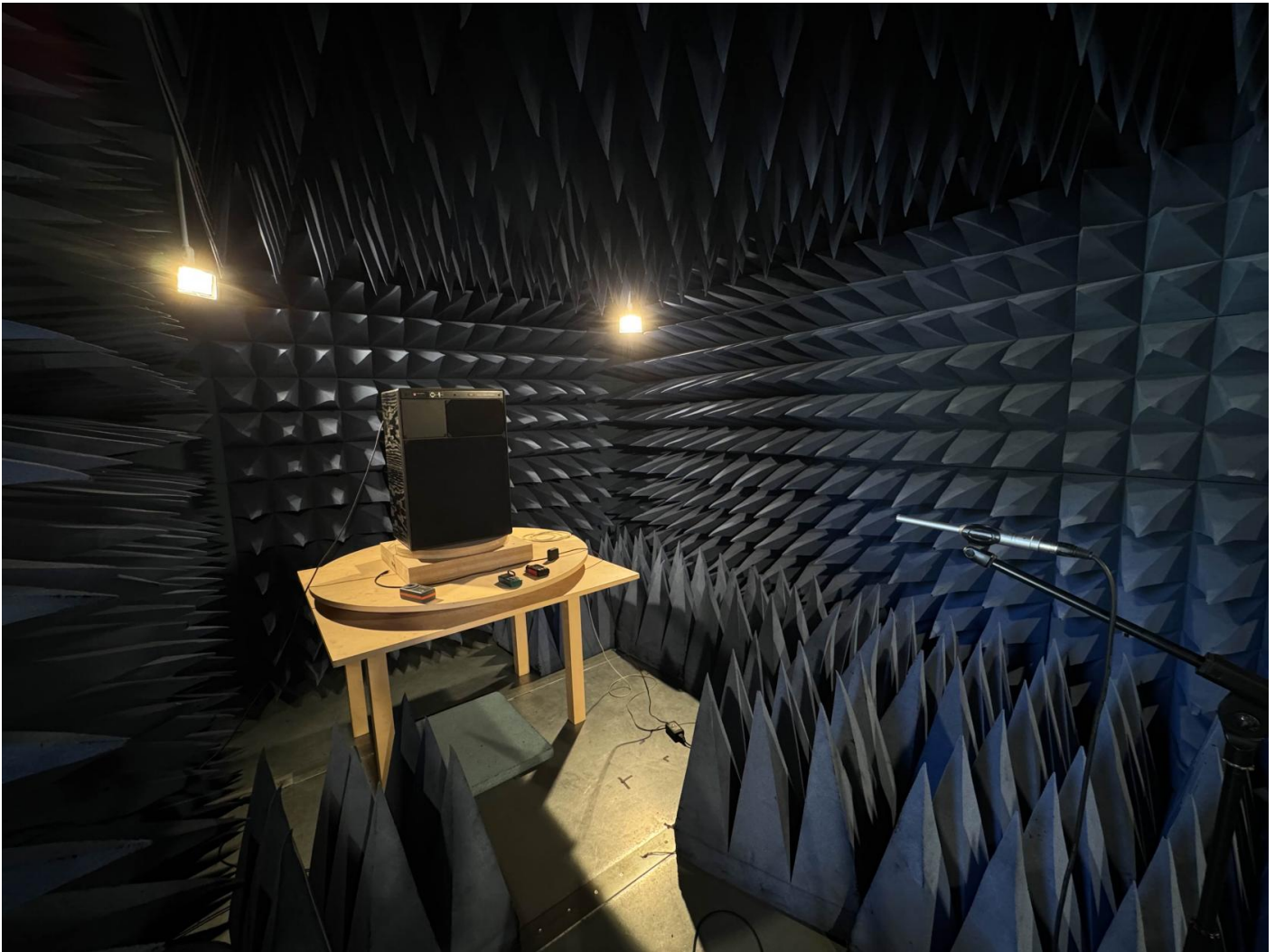
Prise de mesures dans la chambre anéchoïque de l'ENSSAT de Lannion.
